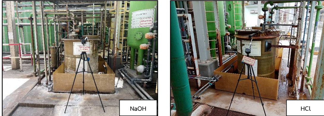
ภาพที่ 3.104 การตรวจวัดไฮโดรเจนคลอไรด์ (HCl) และโซเดียมไฮดรอกไซด์ (NaOH) ในสถานที่ทำงาน บริเวณอาคารผลิตน้ำปราศจากแร่ธาตุ
