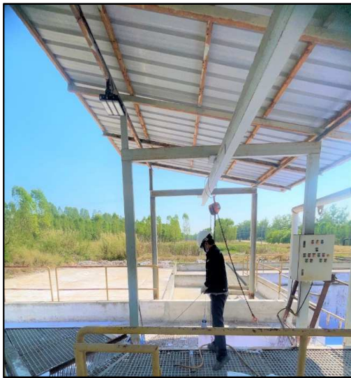
ภาพที่ 3.22 การตรวจวัดคุณภาพน้ำเสียรวมก่อนเข้าระบบบำบัดน้ำเสีย
