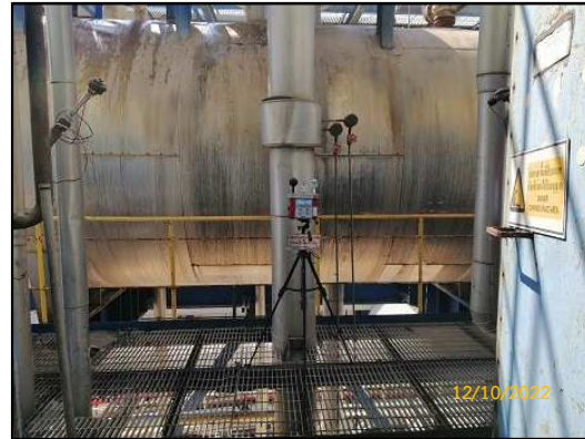
ภาพที่ 3.102 การตรวจวัดความร้อนในสถานที่ทำงานบริเวณหน่วยผลิตไอน้ำหม้อไอน้ำ 4
