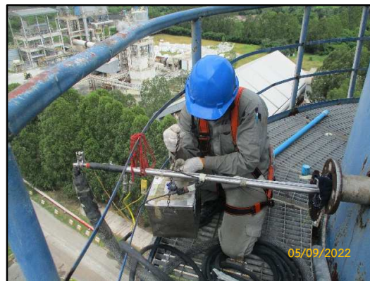
ภาพที่ 3.13 การตรวจวัดก๊าซออกไซด์ของไนโตรเจน ( \text{NO}_x as \text{NO}_2 ) บริเวณปล่องระบายจากหม้อไอน้ำ
